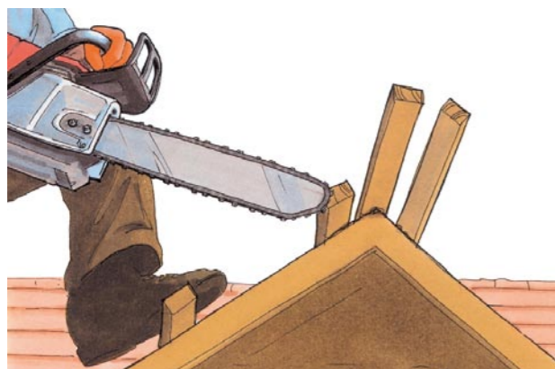
Abgeschrägte Schwertspitze vermindert Rückschlaggefahr
